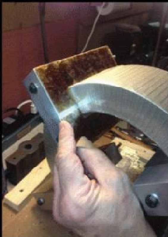
SPODNÉ POKRYTIE SĽUDOVÝMI DOSKAMI
